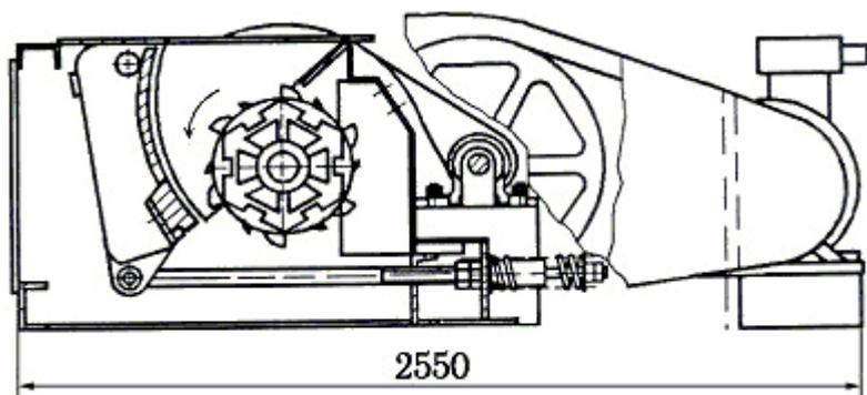
Дробилка одновалковая ДО-1М предназначена для дробления каменных и бурых углей. Может также использоваться для дробления других материалов, прочность которых не превышает прочности угля.
