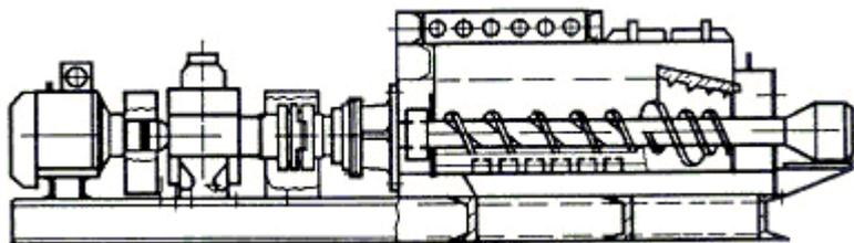
Дробилка-питатель винтовая ВДП-15 предназначена для дробления, грохочения и равномерной выдачи на транспортное устройство бурых и каменных углей.
