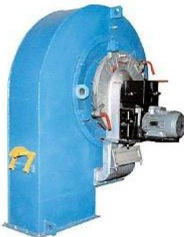
Газомазутные горелки МГМГ-6; МГМГ-8 и МГМГ-10 оснащены механическими мазутными форсунками ФММ-620; ФММ-800 и ФММ-940 применяются для розжига и поддержания горения топлива на стальных водогрейных и паровых котлах или печах и т.п.
