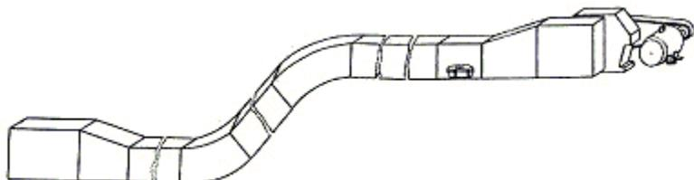
**Установки скребковые УСУ и УСШ** предназначены для транспортирования угля (УСУ) или очаговых остатков (УСШ), по горизонтально-наклонным трассам с помощью разборных цепей. между цепями расположены стальные скребки, передвигающие насыпной груз объемной массой до 1000 кг/м<sup>3</sup>. Размеры кусков могут составлять до 60 мм в поперечнике.
