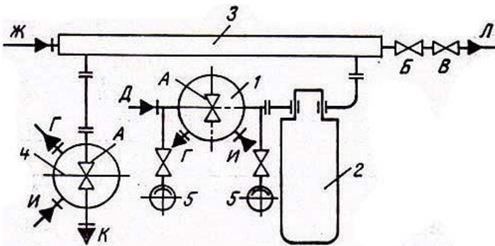
1-фильтр грубой очистки мазута; 2-агрегат электронасосный; 3-подогреватель мазута; 4-фильтр тонкой очистки мазута; 5-манометры.
