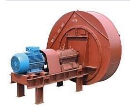
Вентилятор ВДН - Вентилятор Дутьевой с лопатками загнутыми НАЗАД. Так расшифровывается аббревиатура в названии вентилятора данного типа. Этот тип котельного оборудования предназначен и в основном применяется для поддува воздуха в топку промышленного котла с целью улучшения горения топлива и повышает производительность работы котельного агрегата. Температура воздуха, перемещаемого вентилятором в топку, не должна превышать 200-250°C.
