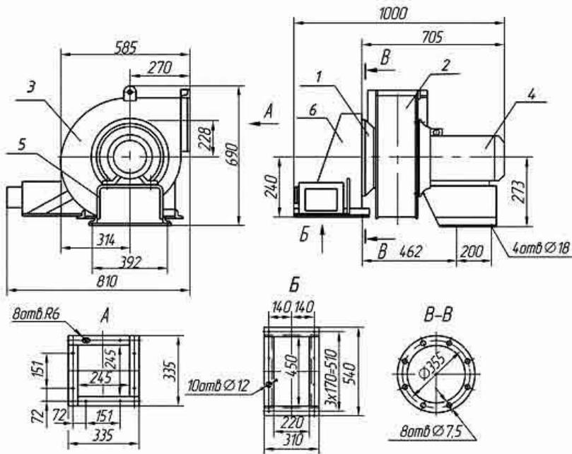
**Обозначения:** 1-всасывающий патрубок; 2-рабочее колесо; 3-корпус; 4- электродвигатель; 5- опорная рама; 6- всасывающий карман с направляющим аппаратом.
