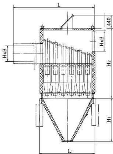
Золоуловитель (циклон батарейный блочный с чугунными элементами) предназначен для сухого улавливания золы, уносимой дымовыми газами из топок паровых и водогрейных стационарных котлов при сжигании твердых золосодержащих топлив.
